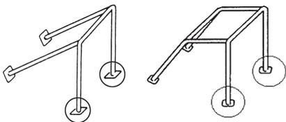
Die Fläche für die Befestigungspunkte der hinteren Abstützungen muss gemäß Art. 253-8.3.2.6 mindestens 60 cm<sup>2</sup> aufweisen (Ausnahme: Überrollkäfige gemäß ASN-Zertifikat oder FIA-Homologationsblatt). Darüber hinaus ist die Fläche der anderen Befestigungspunkte freigestellt, wobei an diesen Punkten die Rohre auch direkt mit der Karosserie verschweißt werden dürfen.
