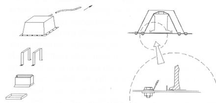
Falls eine Trockenbatterie im Fahrgastraum untergebracht ist, muss sie mit einer kompletten Abdeckung elektrisch isoliert werden.
