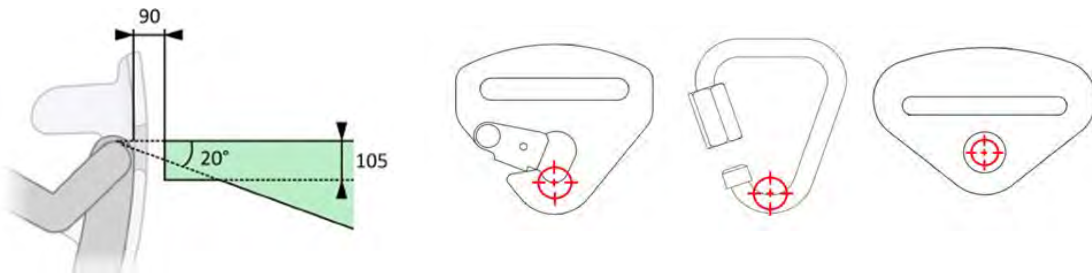
Beispiele von Anlenkpunkten der Gurtbefestigung Zeichnung 253-61-c
